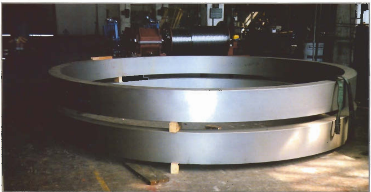
Bandage de roulement. INSTALLATION DE PEQUIVEN-VENEZUELA
