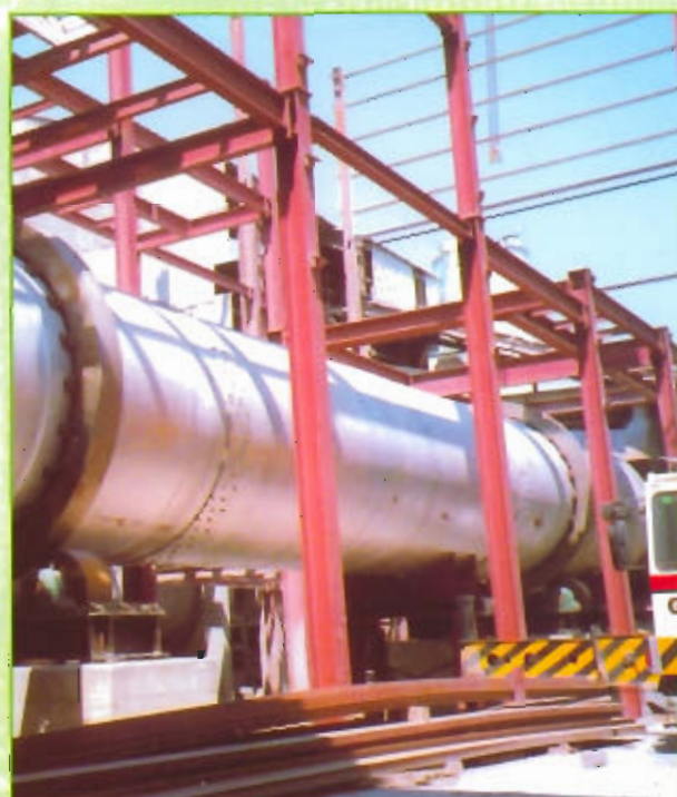
Tambour Sécheur NPK \text{Ø } 3 \text{ m} \times 24 \text{ m L} CNCCC-GUOXI-CHINE
