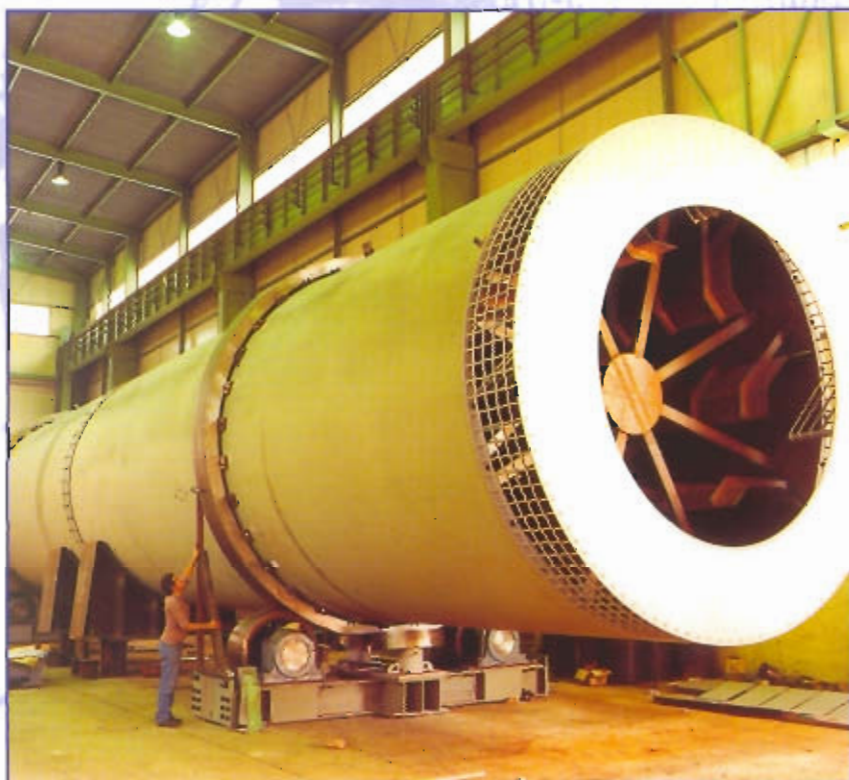
Tambour Sécheur NPK Ø 3,5 m x 28 m L. OMNIA GRANDE PAROISSE (SASOLBOURG-UNION SUDAFRICAINNE)
