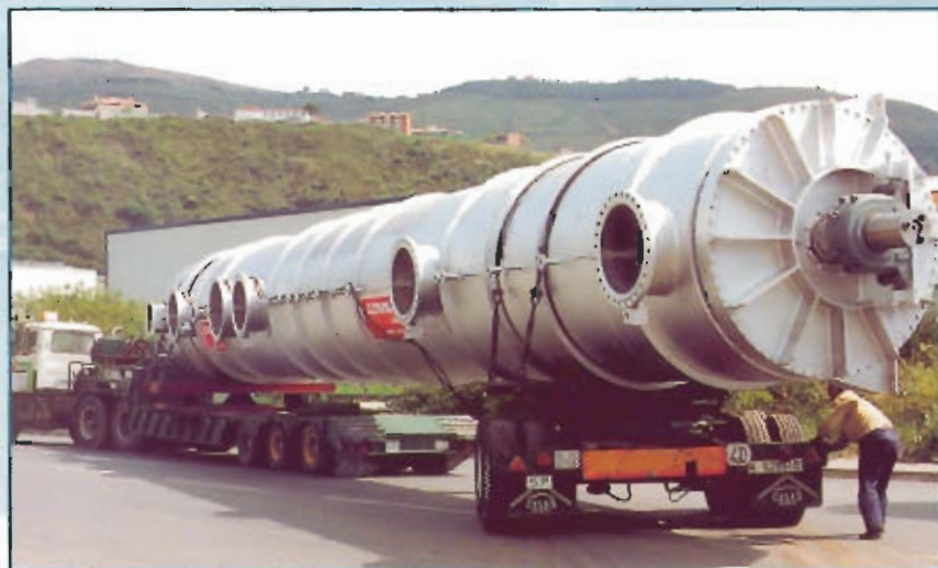
Sécheur indirecte de PVC Ø 3,2 m x 28 m L. Groupe ACETEX (CANADA)
