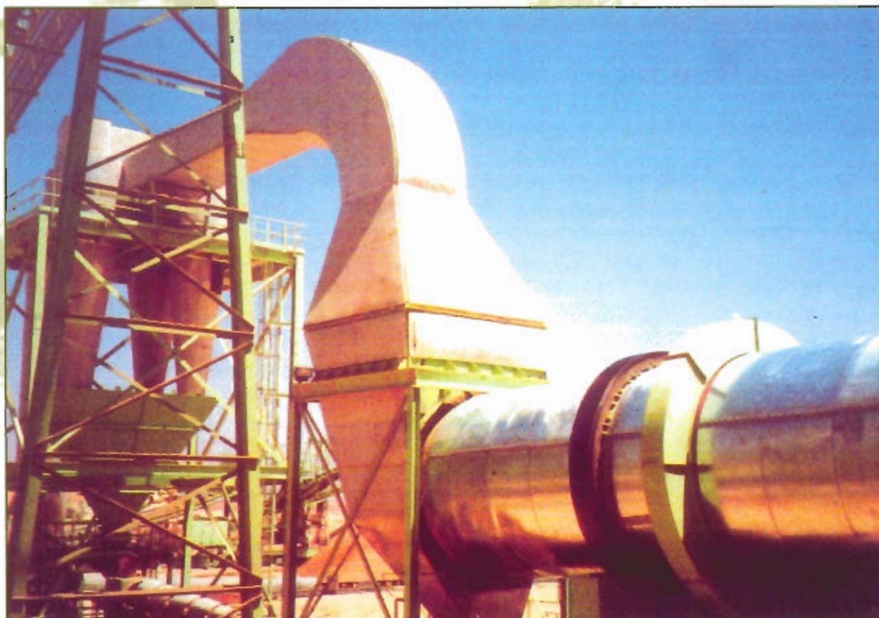
Calcinateur de cendres volantes Ø 2,8 m L x 22 m L. INDUMETAL-BILBAO-ESPAGNE
