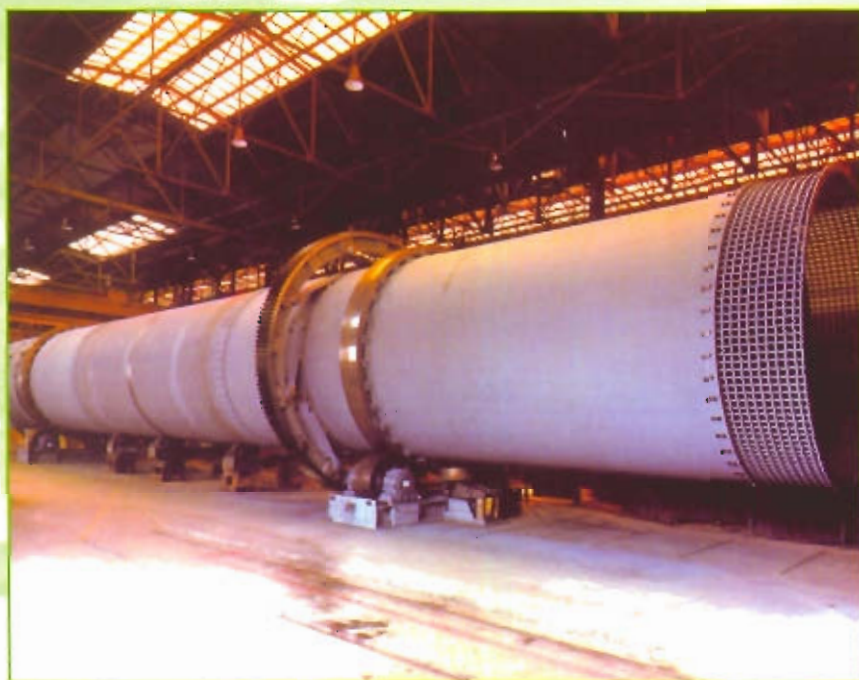
Tambour Sécheur pour Engrais Granulés \text{Ø } 3,2 \text{ m} \times 28 \text{ m L} INABONOS GROUPE ROULLIER (LODOSA-ESPAGNE)
