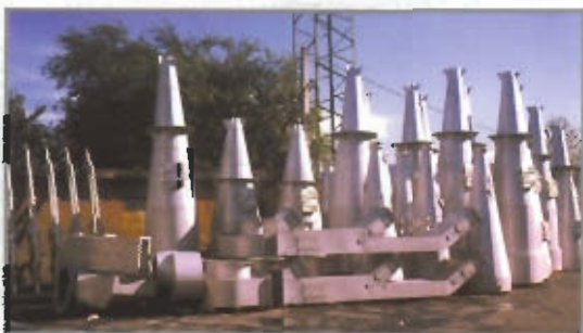
Cyclones de Dépoussiérage pour Sécheur UHDE-ALLEMAGNE pour IFF-ARKLOW-IRLANDE
