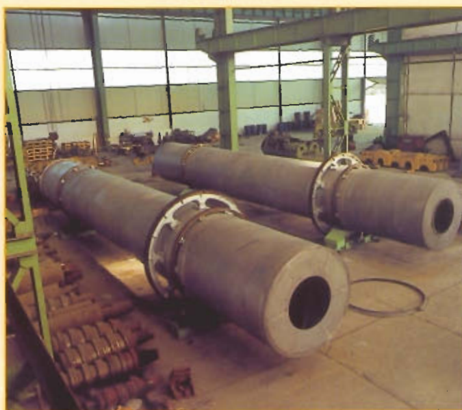
Tambour Sècheur et Refroidisseur en inox de Sulfate d'ammoniac PHILPHOS - PHILIPPINES
