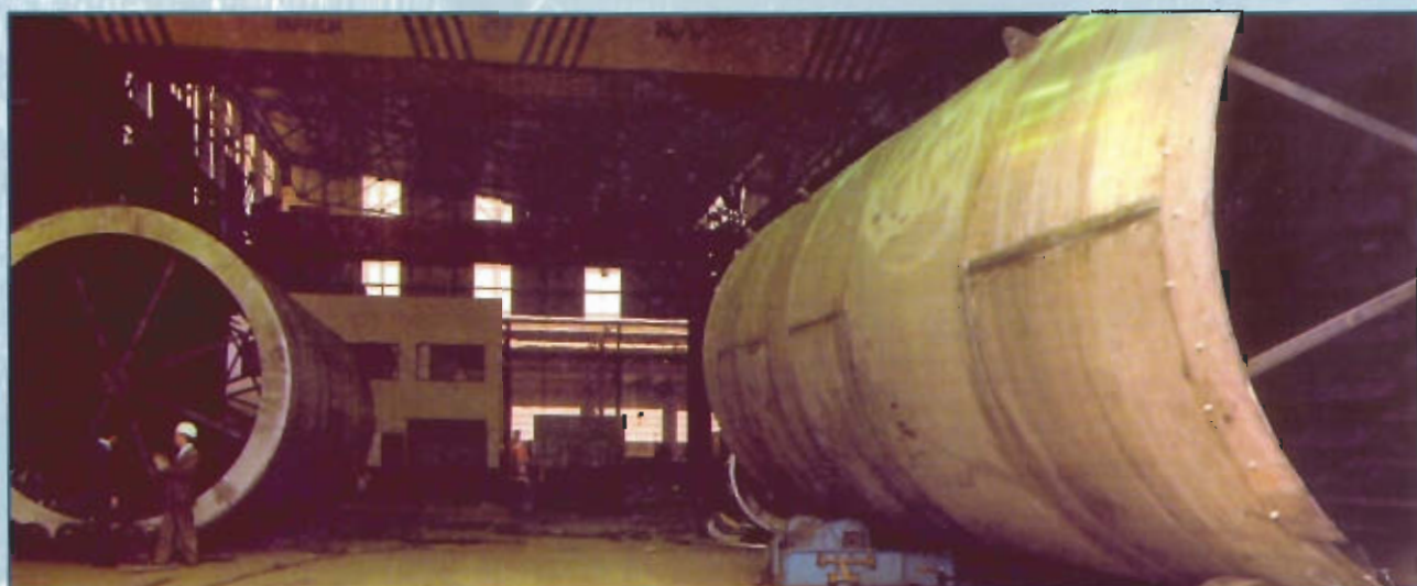
Tambour en acier inox massif pour nitrate d'ammoniac, épaisseur 50 mm. Dimensions Ø 4,5 m x 30 m L FERTIBERIA (SAGUNTO-ESPAGNE)
