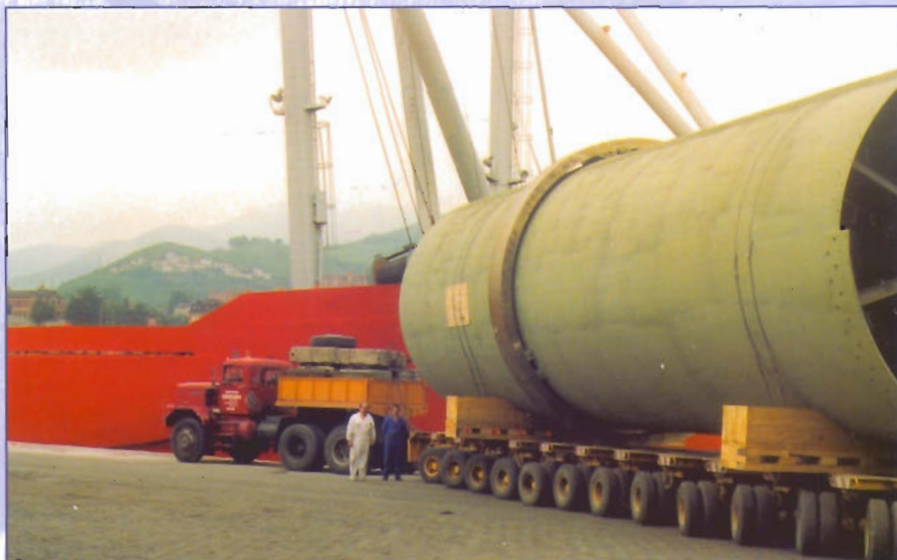
Tambour Sécheur Ø 4,95 m x 31,5 m L pour NPK, DAP et GTSP - SABIG-TPL (ARABIE SAOUDITE)
