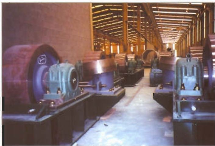
Rodaduras en Taller para expedición. PLANTA ABOCOL-COLOMBIA
