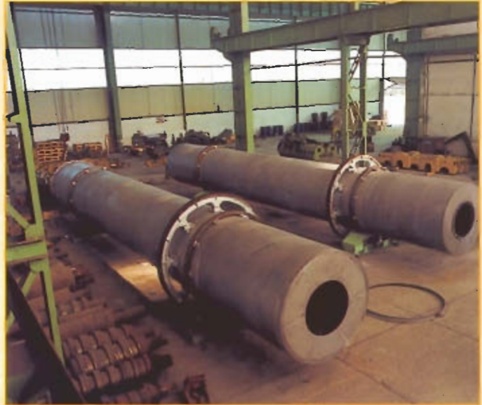
Tambores Secador y Enfriador en inoxidable de Sulfato Anónico PHILPHOS-FILIPINAS
