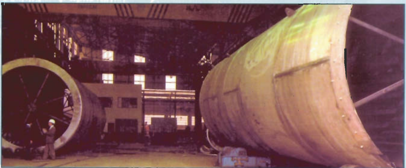
Tanques de acero inoxidable macizo para nitrato amónico espesor 50 mm. Dimensiones Ø4,5m x 30mL. FERTIBERIA (SAGUNTO-ESPAÑA)
