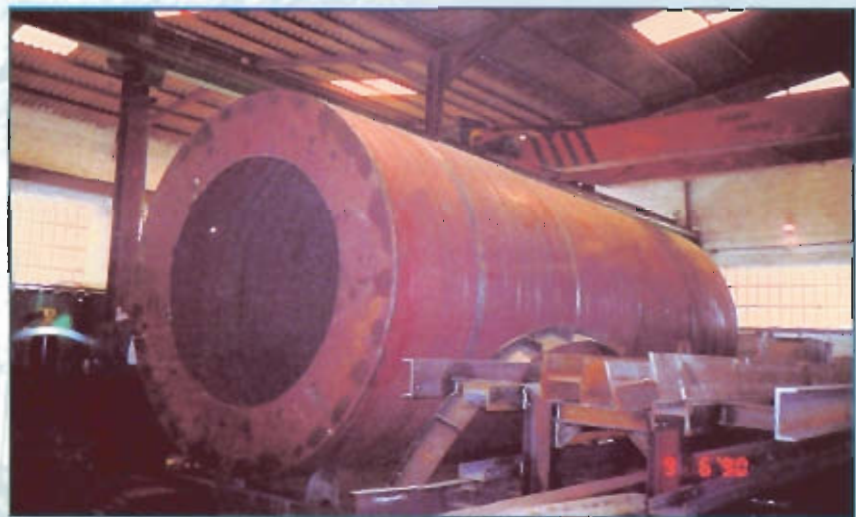
Granulador de NPK Petroquímica GRESIK-II (INDONESIA)
