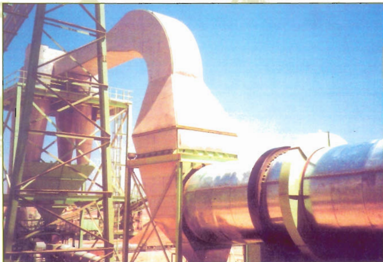
Calcinador de Cenizas Volantes Ø2,8mL. x 22mL INDUMETAL-BILBAO-ESPAÑA.
