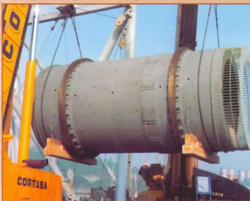
Granulator Drum Ø 2,6 m x 6,5 m L. CNCCC-YUNAN-CHINA
