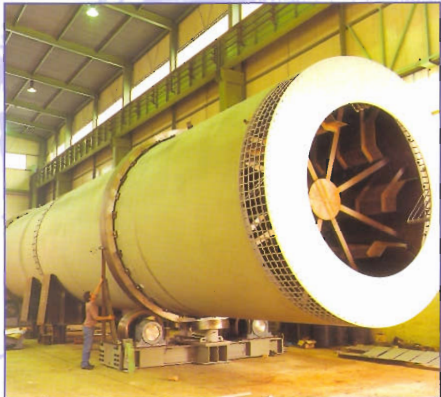
Rotary Dryer for NPK Ø 3,5 m x 28 m L. OMNIA GRANDE PAROISSE (SASOLBOURG-SOUTHAFRICA)
