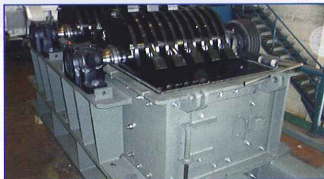
Molino de Doble Rotor de Martillos Petrokimia Gresik - INDONESIA
