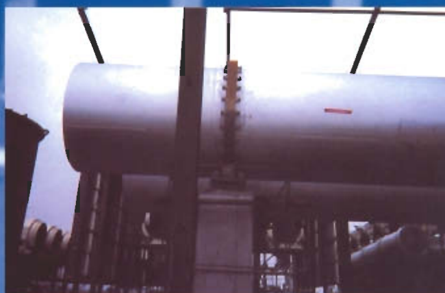
Tambor de secado, 3,6 m diámetro x 25 m Longitud.
