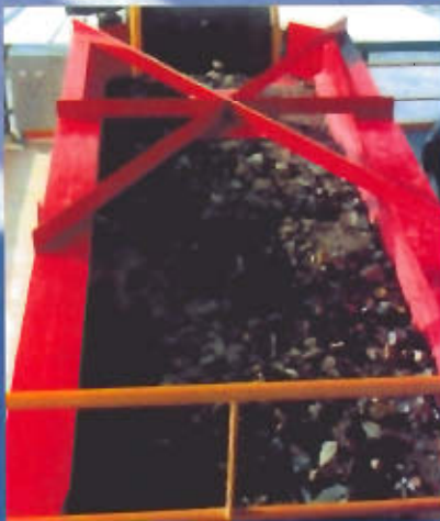
Criba para clasificación de RSU bruto.
