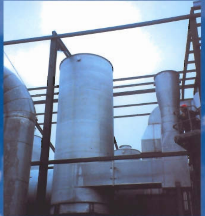
Lavadores con efecto Venturi y ciclónico.
