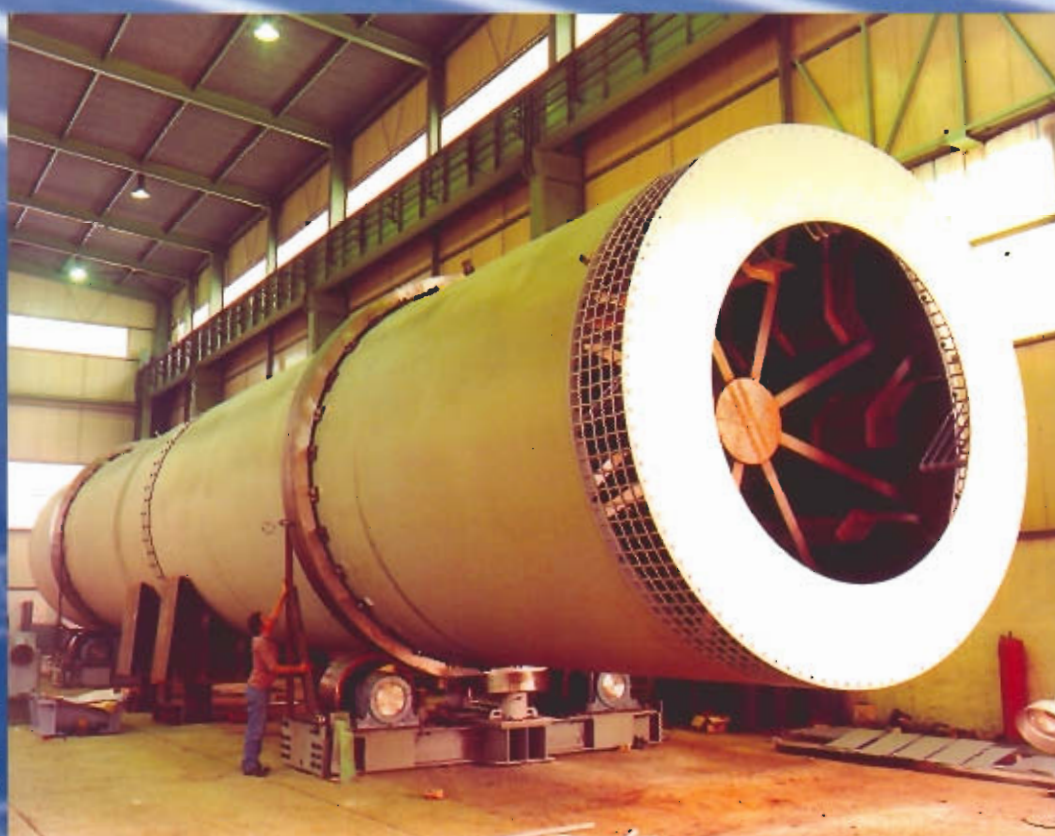
Tambor secador. 4,6 m. de diámetro x 29 m. de longitud.
