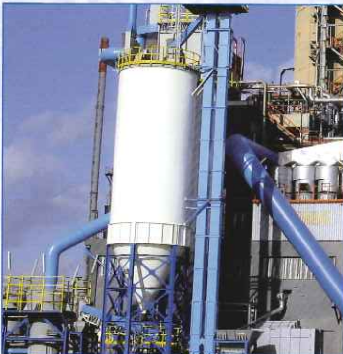
Silos et éleveurs à godets: FERTIAL (Annaba, Algérie) Dolomite.
