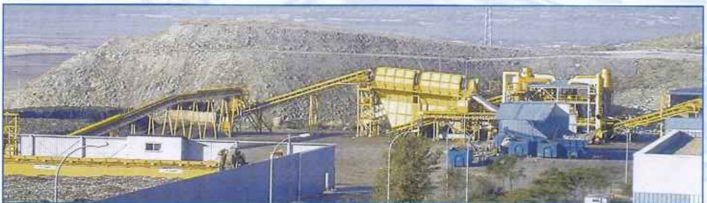
Alimentation de "trommels" COMSPAIN pour affinage de compost à URBASER (Madrid, Espagne).
