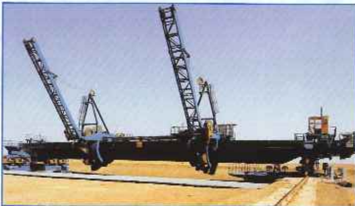
Ramasseuse type pont avec deux roue-pelles de 3.500 T/h; ENDESA (As Pontes de García Rodríguez, Espagne) pour Charbon, technologie de KOCH.
