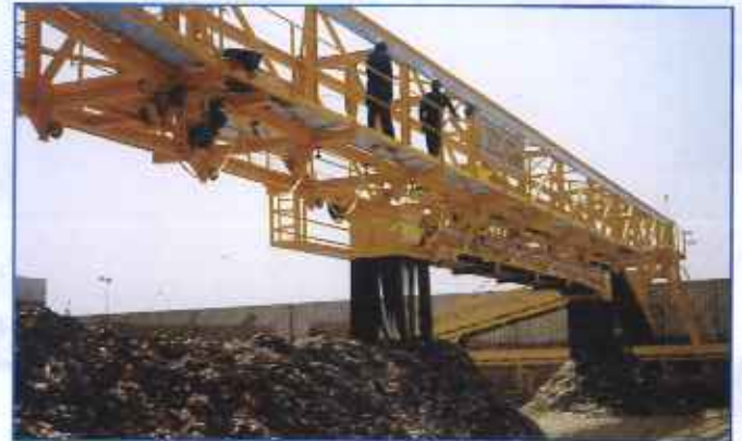
Portique chargeur avec bande réversible et mobile: DRAGADOS TIRMAIDRID (Madrid, Espagne) déchets urbains (ordures ménagères).
