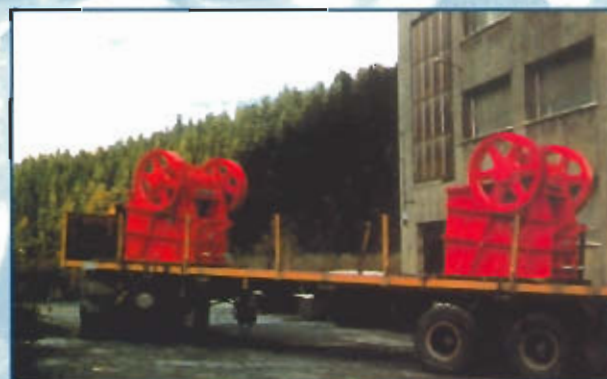
CONCASSEUR à MACHOIRES TYPE 800 x 1000 mm ECIMETAL - CUBA
