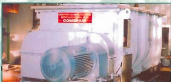
Malaxeuse pour 100 T/h d'urée fondue, etc. Dongbu Chemical NPK-DAP - CORÉE
