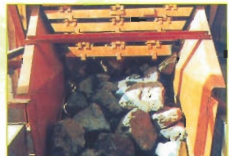
Extracteur- Précribleur Basalte 1600 x 4500 mm Débit 600 T/h (0-1000 mm). Coupure 150 mm CYT Canaries - ESPAGNE
