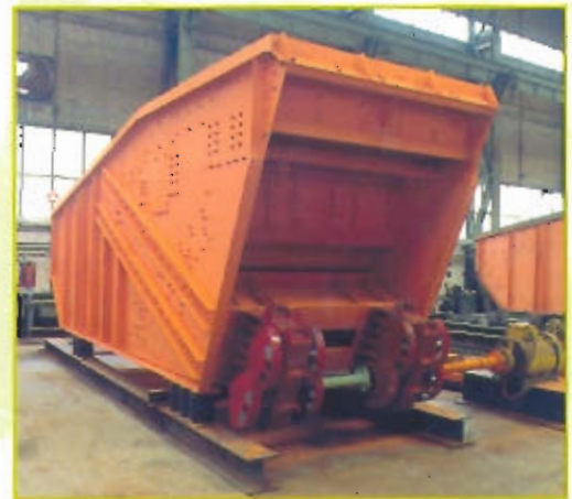
Extracteur Précribleur chaux 2500 x 8000 mm Calcaire. Débit 2500 T/h (0 - 1500 mm). Coupure 250 mm - Fl - Smidth - DANEMARK
