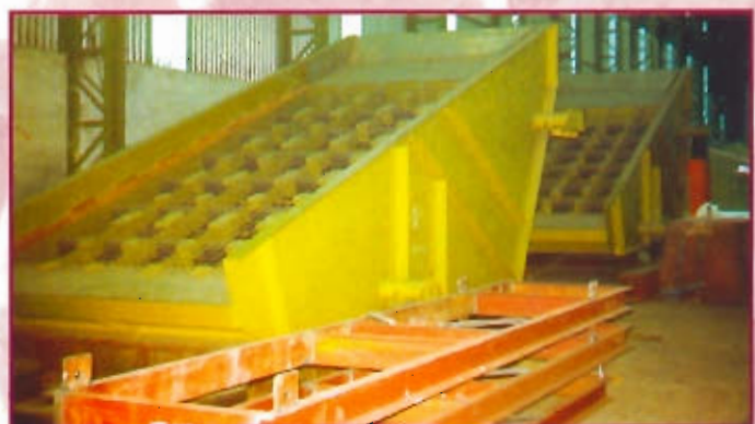
Cribles de nettoyage. Charbon Débit: 2500 T/h. Type 2000 x 7000 mm - Endesa - ESPAGNE
