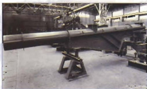
Alimentateur tubulaire Type 800Ø x 2500 mm Débit: 300 T/h Fertilizer Co. TAIWAN
