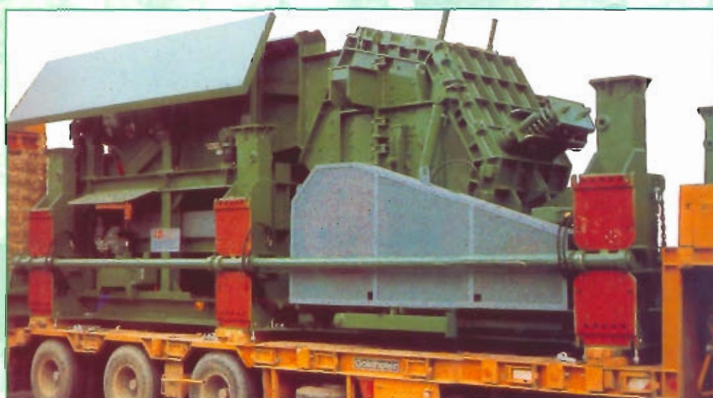
Installation mobile primaire. Précriblage et broyage - Carrière Granada - ESPAGNE
