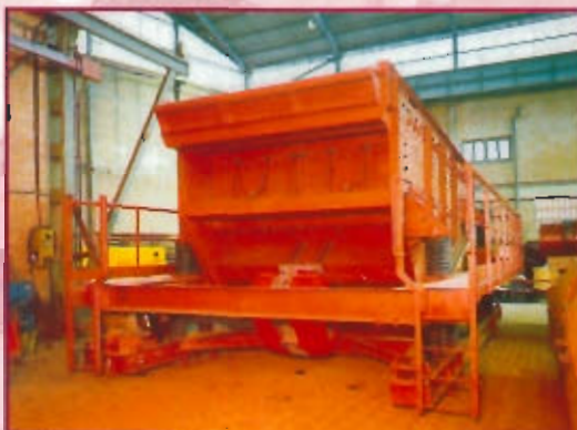
Crible Horizontal avec contremasse. Minerai de fer Débit: 600 T/h. Type 2000 x 7000 mm Hispanobras - BRÉSIL
