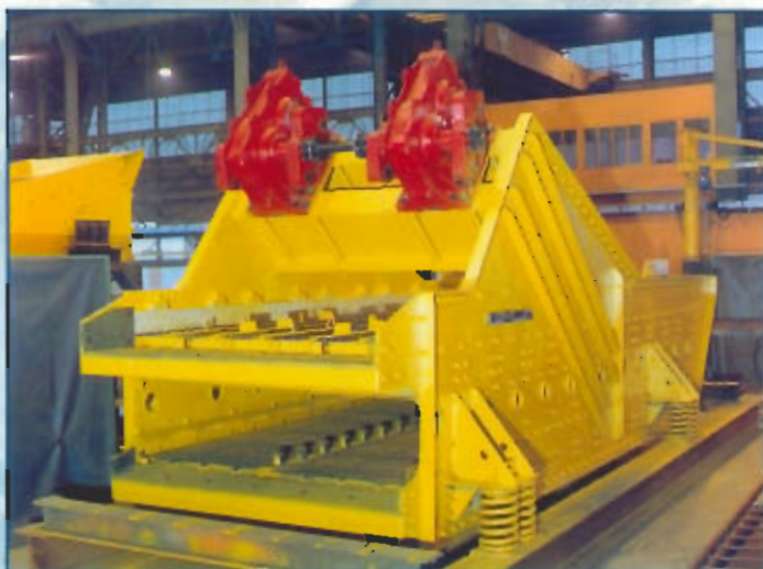
CRIBLE HORIZONTAL 2000 x 6000 mm Deux étages GAFSA- TUNISIE
