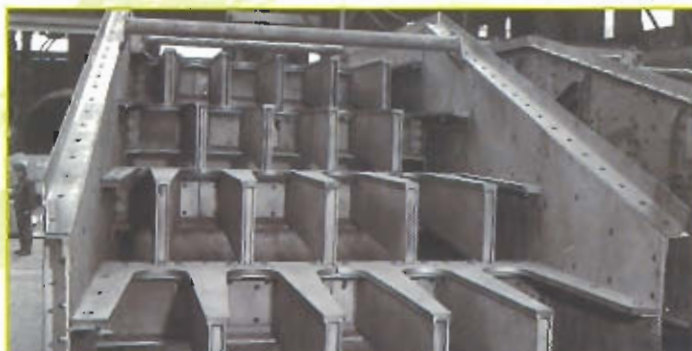
Extracteur- Précribleur Phosphate 2000 x 6000 mm Débit 1800 T/h (0-1500 mm). Coupure 200 mm OCP MAROC
