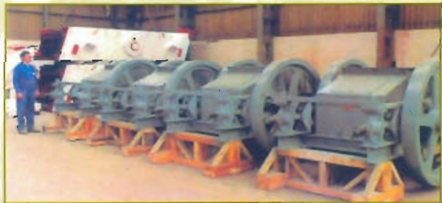
Broyeurs à cylindres et marteaux G.ECO General Fertilizer Co. - SYRIE
