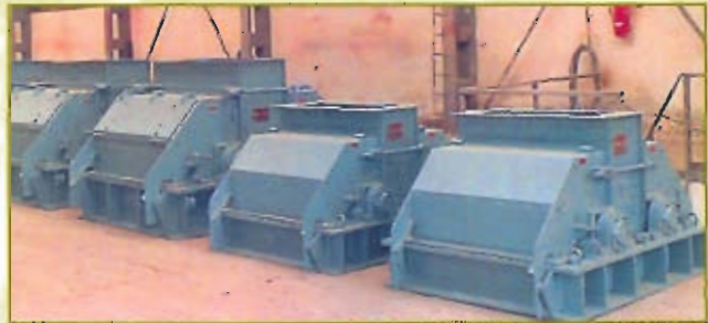
Broyeurs à cylindres Chemical Bartow - USA
