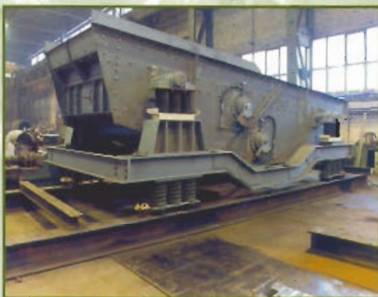
Crible avec double actionnement et contremasse. Type 2200 x 7000 Débit 80 T/h Résidus organiques. Barcelone - ESPAGNE
