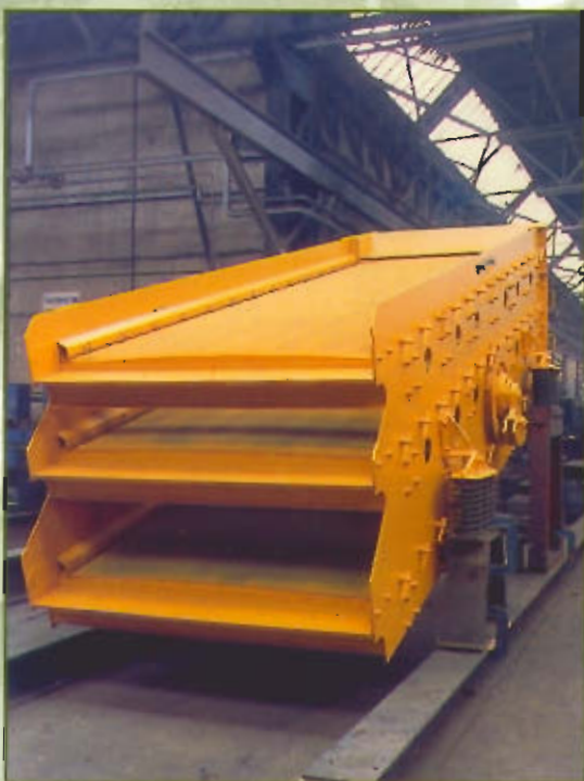
Crible 3 étages. Type 1500 x 5000 Débit 400 T/h. Deblai - FRANCE
