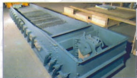
Alimentateur Refroidisseur 800 x 2000 mm Type: 800 x 2000. Débit: 40 T/h - NIGERIA
