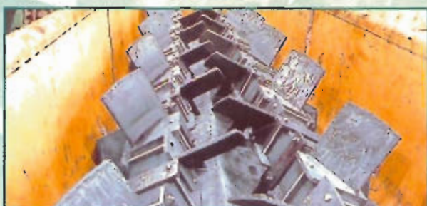
Type de pelles démontables de granulateur 300 T/h de NPK Installation de Novomoskowsk - RUSSIE
