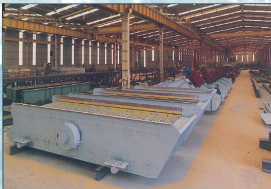
CRIBLE HORIZONTAL 2000 x 6000 mm Deux étages GAFSA- TUNISIE
