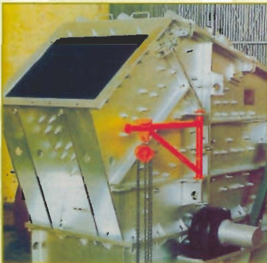
Broyeur à percussion Type 1500 x 1000 mm Carrière Asunción - PARAGUAY
