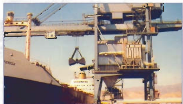
Doseur déchargeur de bateaux Type 2800 x 3000 mm Débit: 2500 T/h Krupp - ESPAGNE
