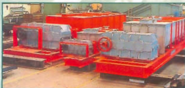
Granulateur à double vis pour 240 T/h de NPK Zorka Azotara Subótica NPK, NA - YUGOSLAVIE
