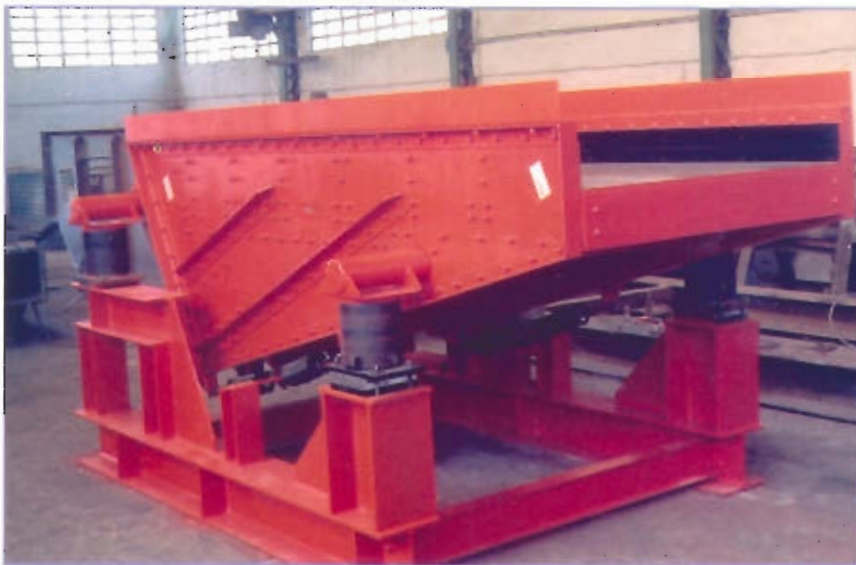
Extractor alimentador 1.200 x 2.500 mm Caudal 700 T/h POTASA CARDONA - ESPAÑA
