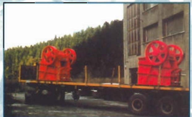
Machacadoras de mandíbulas 800 x 1.000 mm ECIMETAL - CUBA
