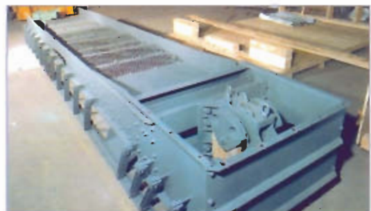
Alimentador enfriador 800 x 2.000 mm Capacidad 40 T/h. coque - NIGERIA
