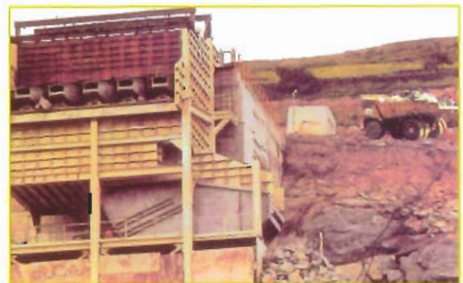
Conjunto de Precibador y Dedos Vibrantes clasificación de escollera BILBAO - ESPAÑA
