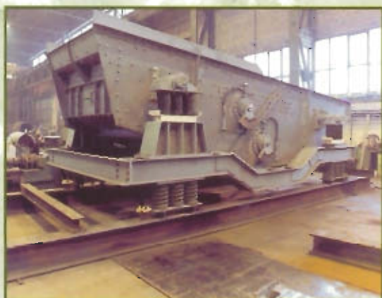
Criba residuo orgánico con doble accionamiento y contramasa 2.200 x 7.000 mm Capacidad 80 T/h ESPAÑA
