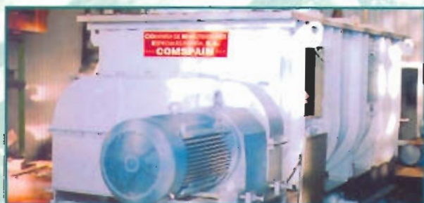
Mezclador para 100 T/h mezcla de urea fundida, etc. Planta NPK - DAP - DONGBU CHEMICAL - KOREA
