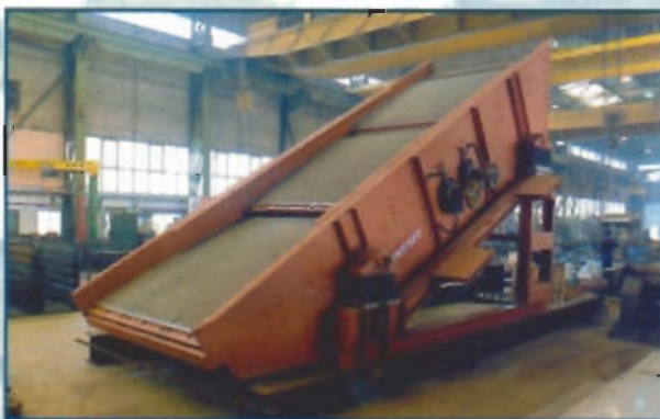
Criba inclinada 2.500 x 8.000 mm con doble acto mecánico. LUZHAY-CHINA
