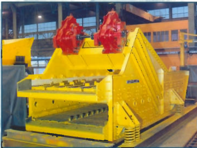
Criba horizontal 2.000 x 6.000 mm biplana GAFA - TÚNEZ
