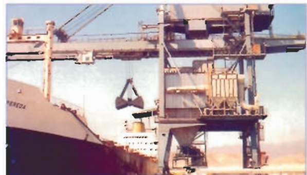
Dosificador descarga de barcos 2.800 x 3.000 mm Caudal 2.500 T/h. Krupp Carboneras. ALMERÍA - ESPAÑA
