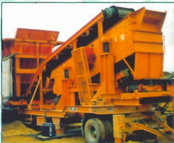
Instalación móvil de Cribado Áridos TRUJILLO - PERÚ
