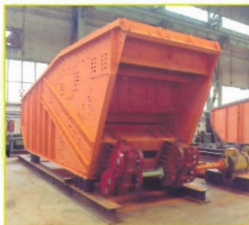
Extractor Precribador de Caliza 2.500 x 8.000 mm Caudal 2.500 T/h (0 - 1500 mm) corte 250 mm FL SMIDTH - DINAMARCA
