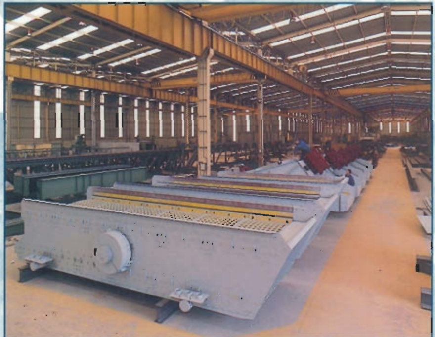
Cribas inclinadas y horizontales Mina de fostato GADFA - TÚNEZ
