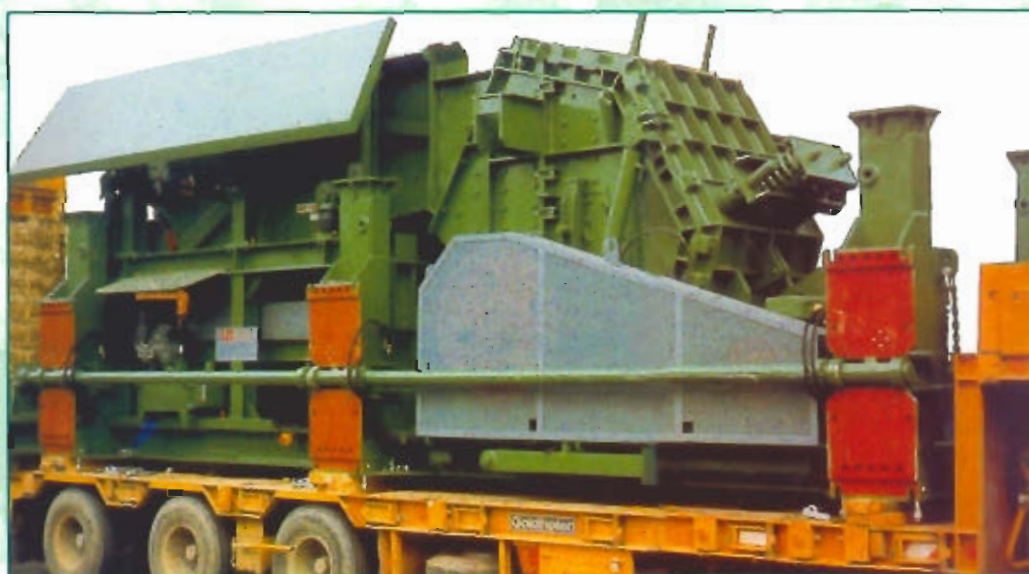
Instalación móvil primaria Precribado y Machaqueo. Áridos autovía - GRANADA - ESPAÑA
