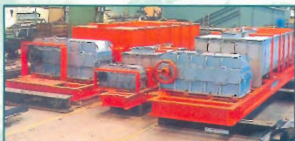
Granuladores de doble tornillo para 240 T/h de NPK. ZORKA AZOTARA SUBOTICA - YUGOSLAVIA
