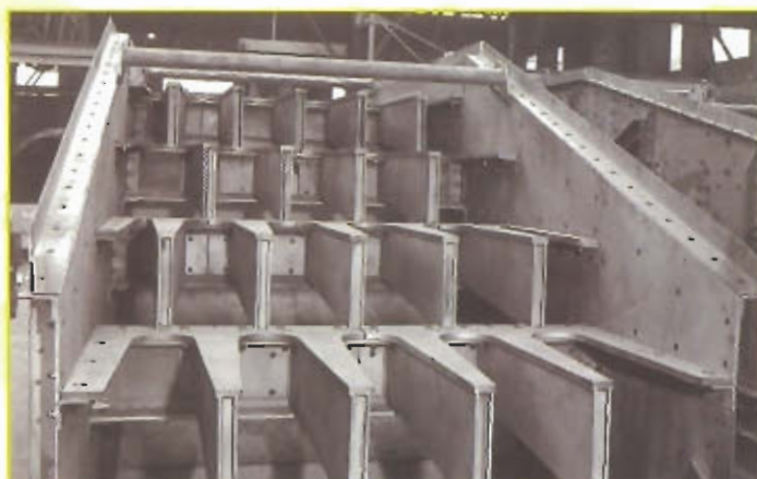
Extractor Precribador de Fosfato 2.000 x 6.000 mm Caudal 1.800 T/h (0 - 1.500) corte 300 mm - OCP MARRUECOS
