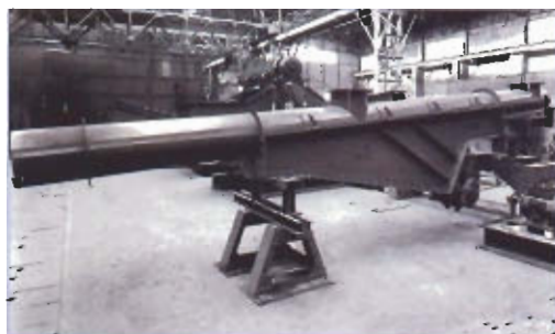
Dosificador Tubular 800 x 2.500 mm Capacidad 300 T/h. FERTILIZER. CO. TAIWAN
