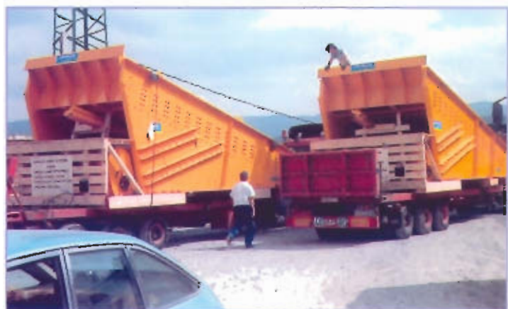
Alimentadores 2.750 x 8.000 mm Caudal 3.800 t/h. GUAVIO - COLOMBIA
