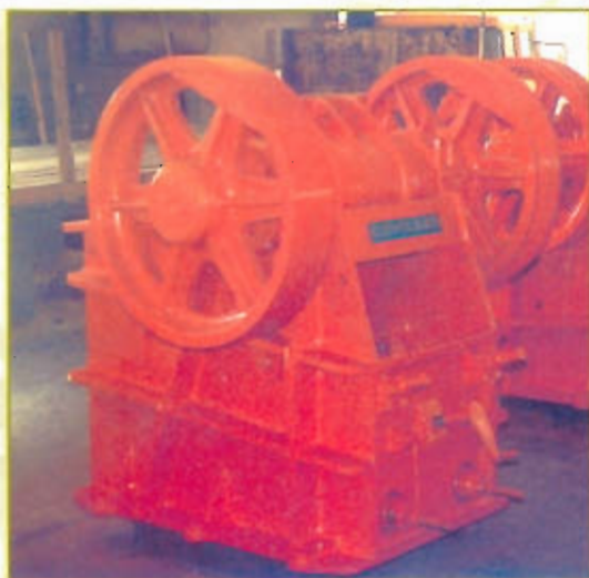
Machacadora de Mandíbulas Mina Cienfuegos - CUBA
