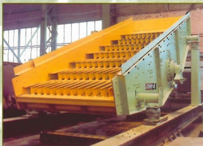
Grizzly Cuarcita 1.750 x 5.000 mm. Producción 500 T/h. Corte 80 mm - NESCO - PARAGUAY
