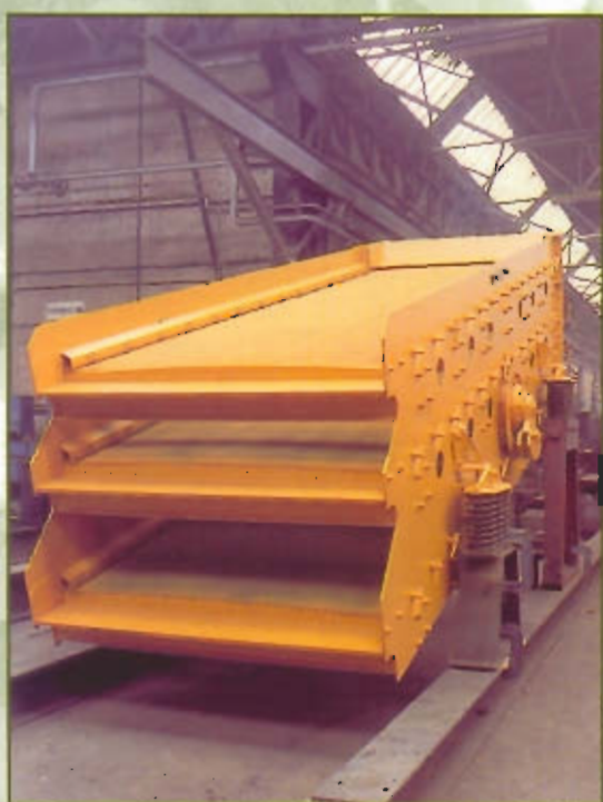
Criba 3 pisos canto rodado 1.500 x 5.000 mm Caudal 400 T/h. Corte 30,12 y 6 mm - FRANCIA
