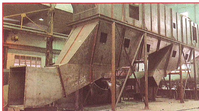
Lit refroidisseur, NA, 32 m 2 , 75.000 kg/h. Fertimex (Mexique).
