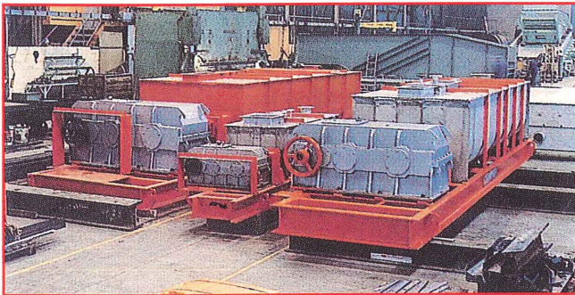
Granulateur à double vis pour 240 T/h. Zorka Azotara Subótica (Yugoslavie). NPK, NA.
