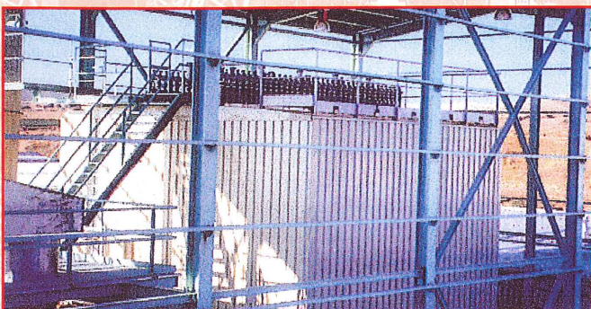
Filtre à manches "jet" 160-2L-10, Sécheur + Granulateur + Refroidisseur d'engrais, NPK. Inabonos (Espagne).
