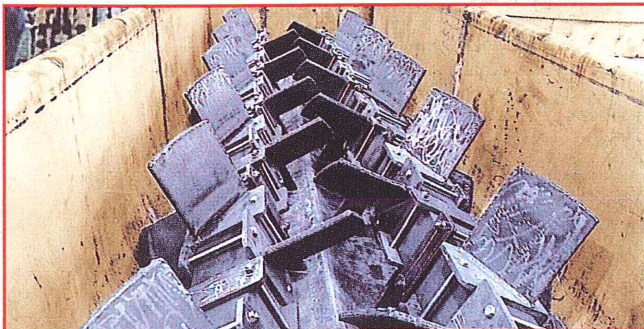
Type de pelles démontables de granulateur pour 300 T/h de NPK. China Petroleum (Xianjiang Luobu popotash Co. Ltd.), (Urumqi, China).
