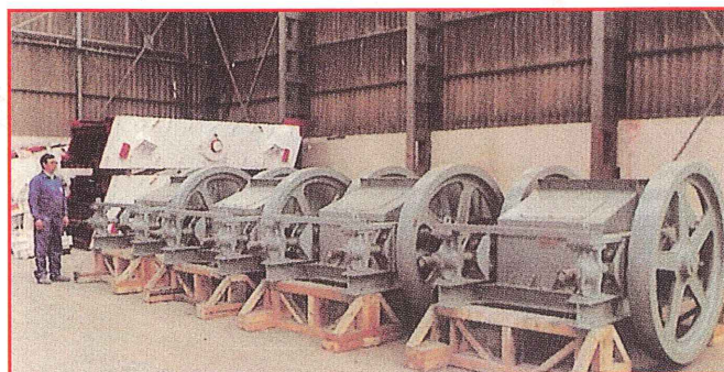
10 broyeurs (cylindres et marteaux), GTSP, 256.000 kg/h (photo partielle). General Fertilizer Co. (Syrie).
