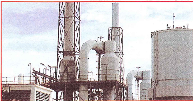
Dépeussierage par "air-mix", 100.000 kg/h, air pour sécheur de sulfate d'ammonium. E.I. Aragonesas (Espagne).
