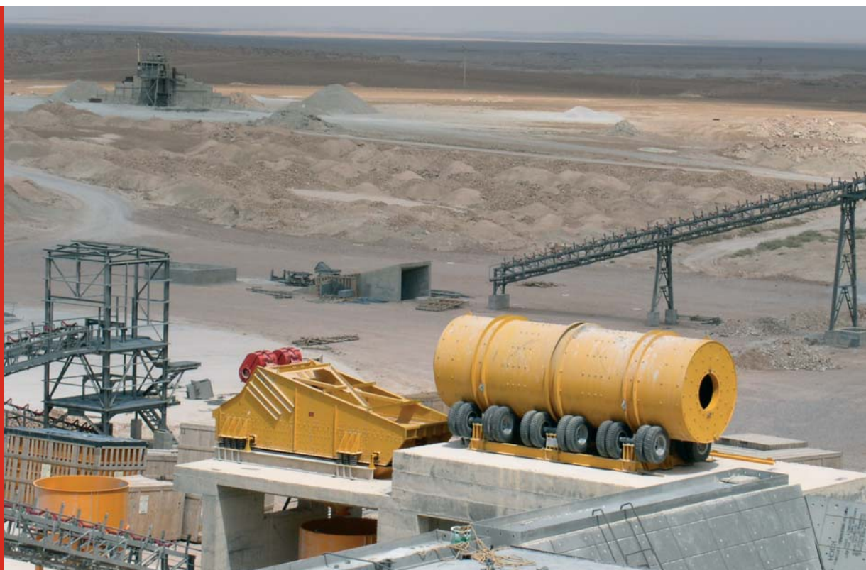
Crible horizontal VTT 2.500 x 6.000 mm avec trommel débourbeur
