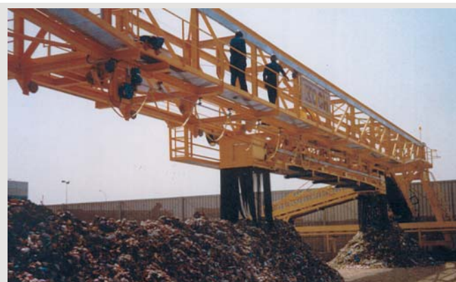
Portique chargeur avec bande réversible et mobile: DRAGADOS TIRMADRID (Madrid, Espagne). Déchets urbains (ordures ménagères).
