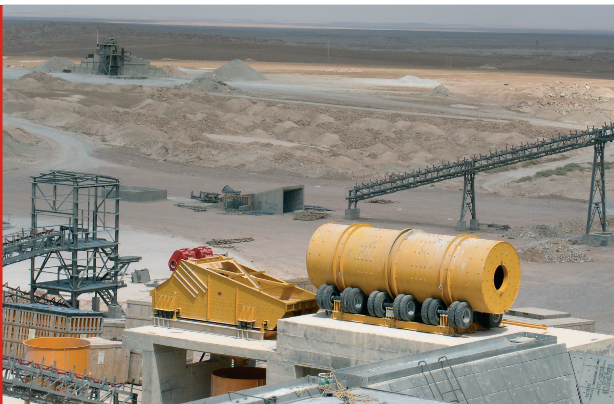
Criba horizontal VTT 2500 X 6000 con trómel lavador
