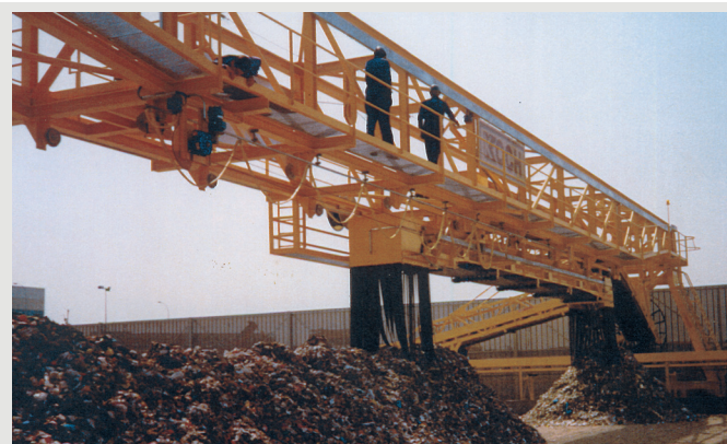
Pórtico cargador con cinta reversible y móvil: DRAGADOS TIRMADRID (Madrid, España) Residuos Urbanos.
