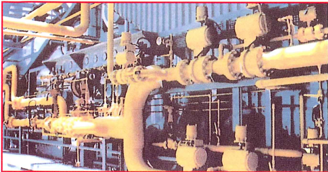
Dos cámaras de combustión, 2 x 30.000 Th/h para secadores TSP, PK, NPK. Asmidal, Annaba (Argelia).
