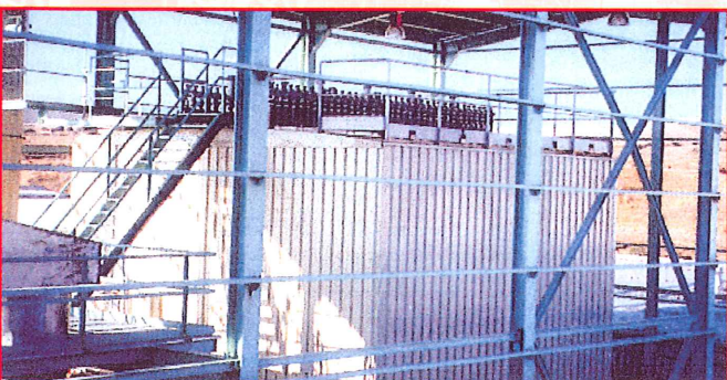
Filtro de mangas "jet" 160-2L-10, Secador + Granulador + Enfriador de abono, NPK. Inabonos (España).
