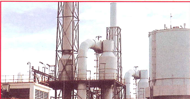
Desempolvado por "Air-Mix", 100.000 kg/h, aire para secador de sulfato amónico. E.I. Aragonesas (Huelva, España).
