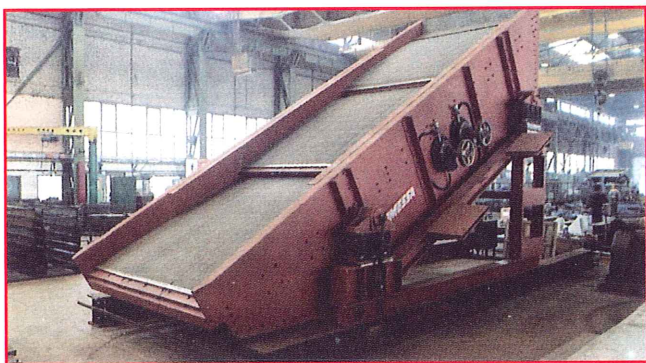
4 cribas de proceso, NPK, 2100 x 5000 mm, 400.000 kg/h. Office Cherifien de Phosphates, Jorf Lasfar (Marruecos).
