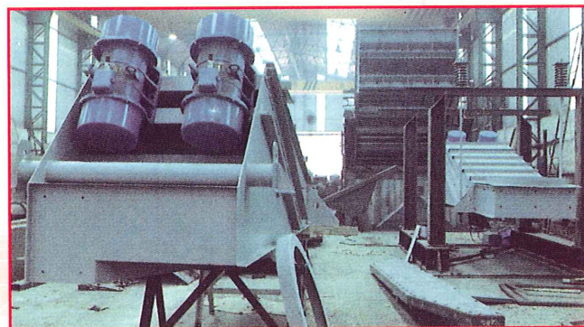
2 alimentadores, NPK, 1500 x 3500 mm, 190.000 kg/h. National Fertilizer Co. (Taiwán)
