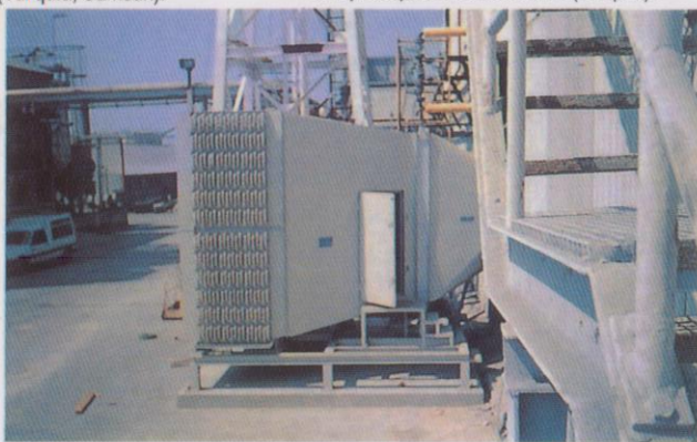
Enfriamiento de NPK, 1.200.000 frig/h. Ferbiberia, planta de Huelva (España).
