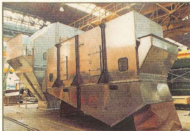
Lit Fluidisé statique pour Sulfate d'ammonium.
