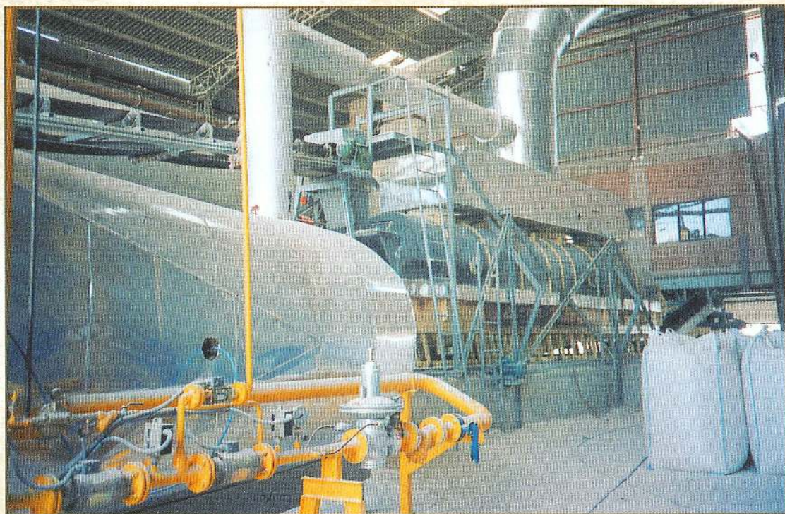
Lit Fluidisé-Haute Temperature pour le séchage d'argile-sepiolite (400° C)
