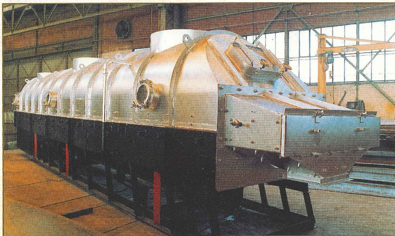
Lit Fluidisé Vibrant sur "lames" pour engrais "organo-minerales"
