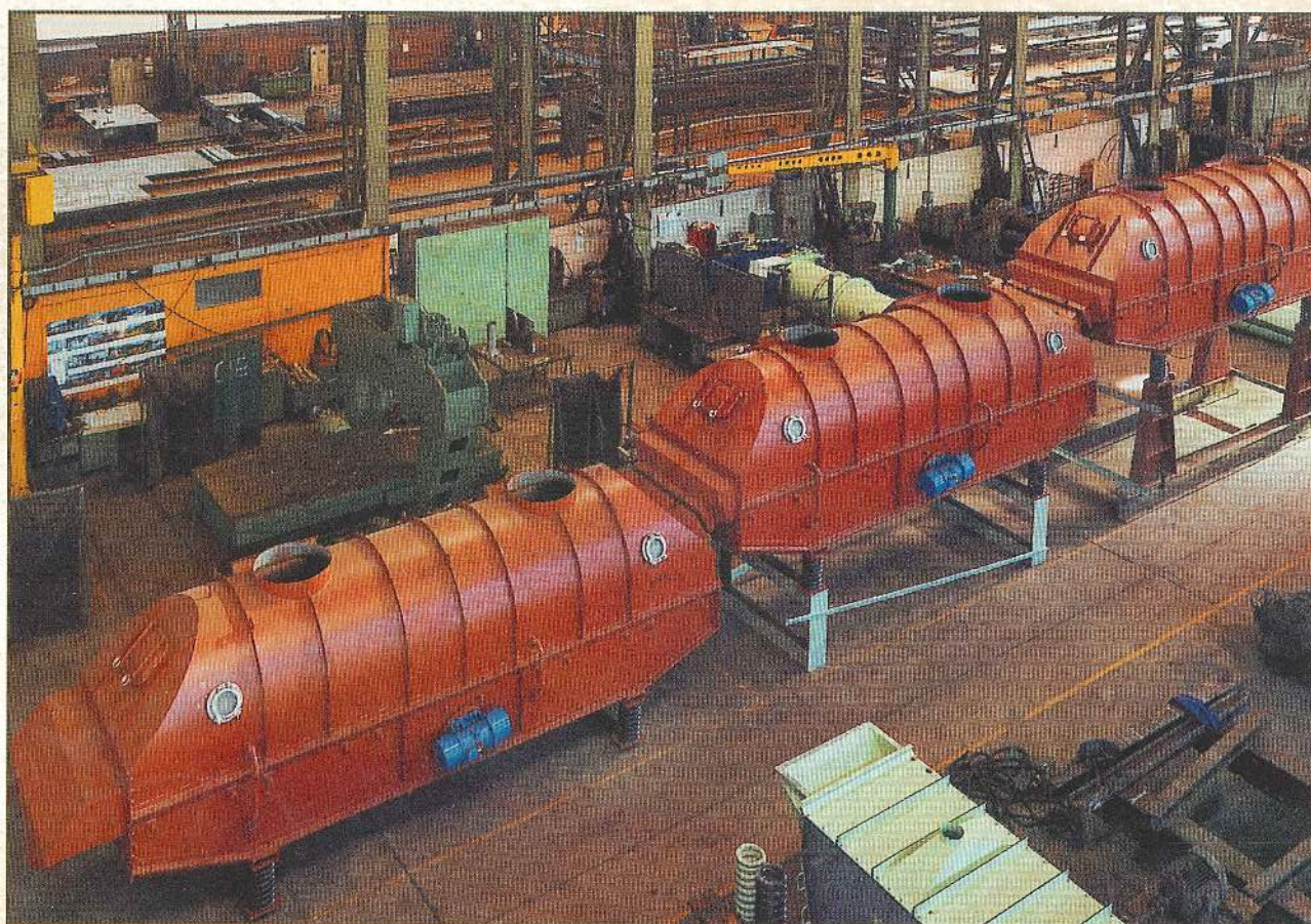
3 Lits Fluidisés Vibrants en "Cascade" - Surface totale 54 m 2
