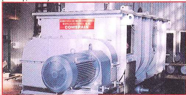
Malaxeuse pour 100 T/h, mélange d'urée fondue, etc. Corée Dongbu Chemical. NPK-DAP. (Corée).
