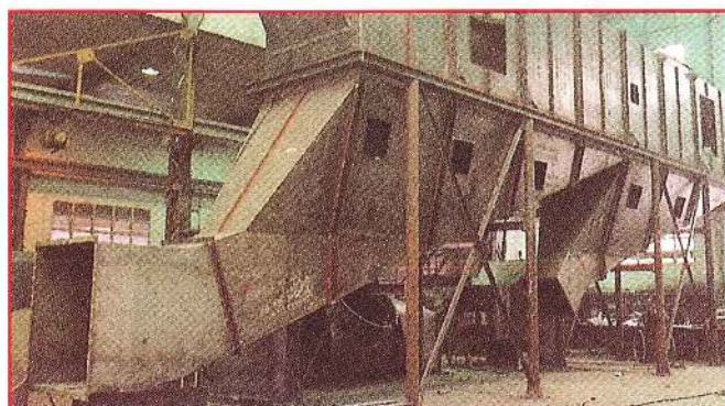
Lit refroidisseur, NA, 32 m 2 , 75.000 kg/h. Fertimex (Mexique).
