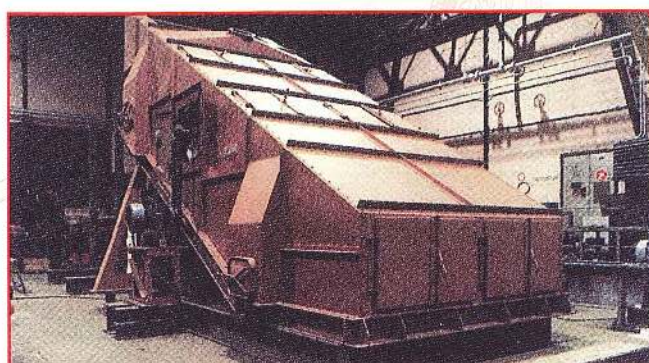
2 cribles de produit marchand, NPK, 2.000 x 5.000 mm, 200.000 kg/h. Namhae (Coree).
