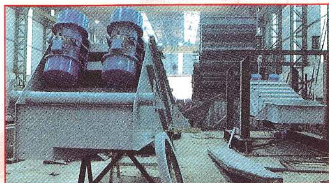
2 alimentateurs vibrants, NPK, 1.500 x 3.500 mm, 190.000 kg/h. National Fertilizer Co. (Taiwan).
