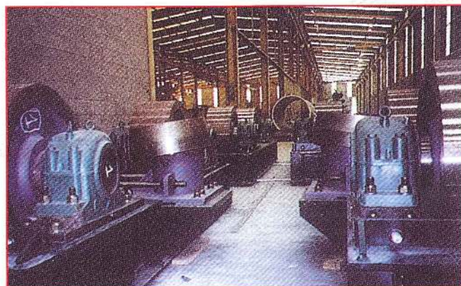
Systèmes de roulement pour une installation de NPK, 310.000 T/an. Petrokimia (Indonésie).
