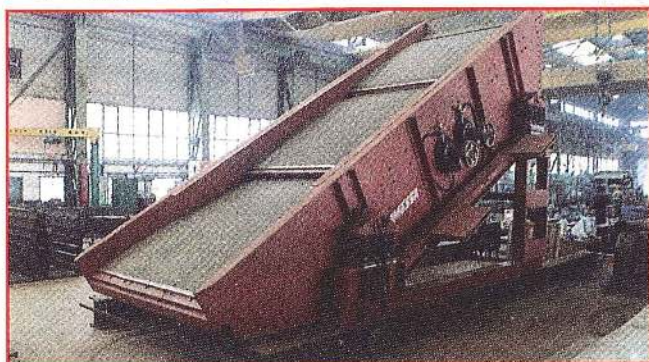
4 Cribles de produit marchand, NPK, 2.100 x 5.000 mm, 400.000 kg/h. Office Chérifien de Phosphates, Jorf Lasfar (Maroc).
