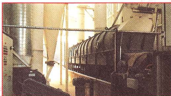
Lit fluidisé vibrant sécheur/refroidisseur, Organo-Minéraux, 20 m 2 , 12.000 kg/h. Industrias Labin (Espagne).
