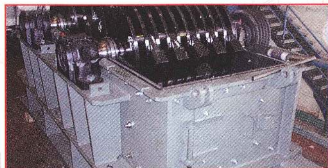
Broyeurs à chaînes/marteaux à double rotor. Petrokimia Gresik (Indonésie).
