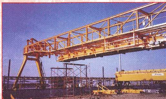
Empileuse et ramasseuse (roue-pelle) pour déchets, installation de compostage. Dragados (Espagne).
