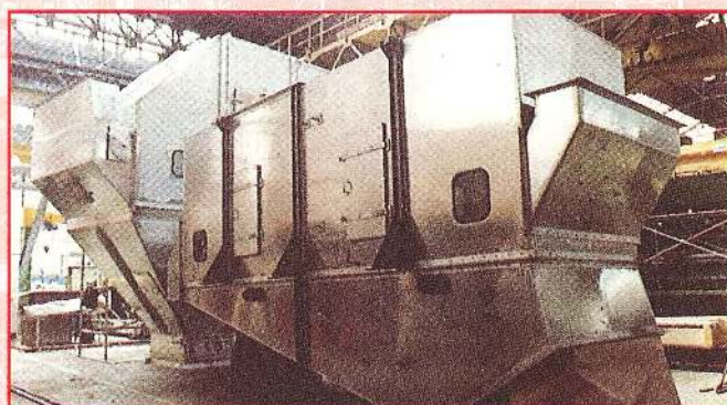
2 lits fluidisés refroidisseurs, NP, 2 x 34 m 2 , 150.000 kg/h. Toyo Engineering (Chine).
