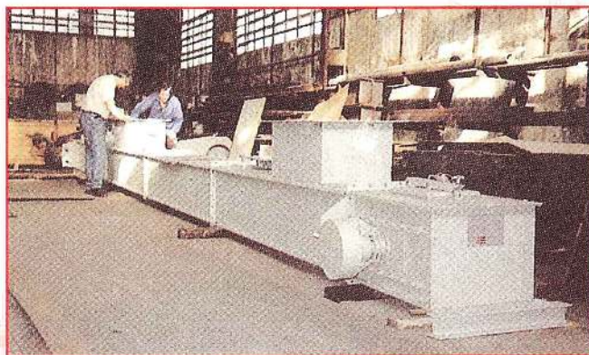
Transporteur à chaîne pour 250 T/h, GTSP. (General Fertilizer Co., Homs (Syrie).
