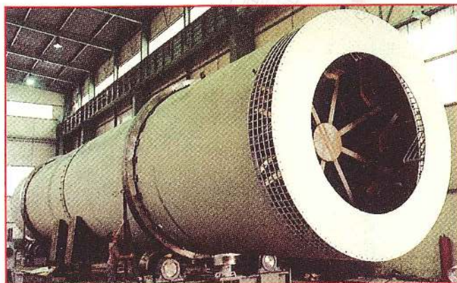
Tambour sécheur, NPK-DAP, \varnothing 4,6 x 30 m, 360 T/h. Siap/Gabes (Tunisie).
