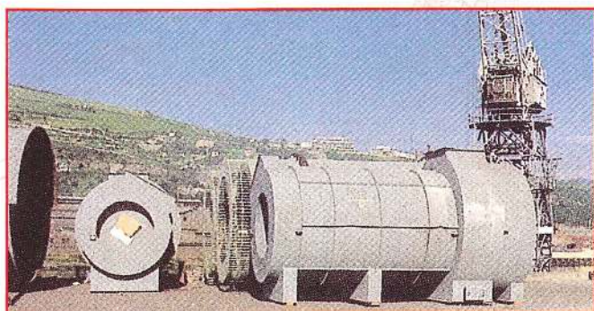
Chambres de combustion de 30.000 et 20.000 Th/h. Technipetrol pour installation de NPK/DAP/GTSP (Italie).
