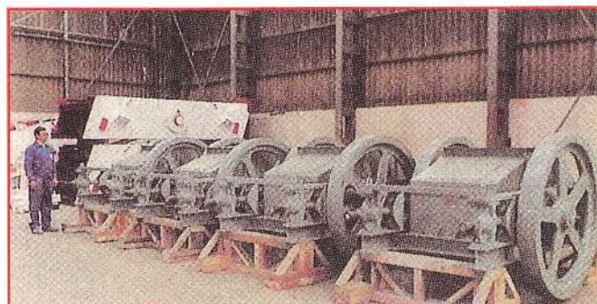
10 broyeurs (cylindres et marteaux), GTSP, 256.000 kg/h (photo partielle). General Fertilizer Co. (Syrie).
