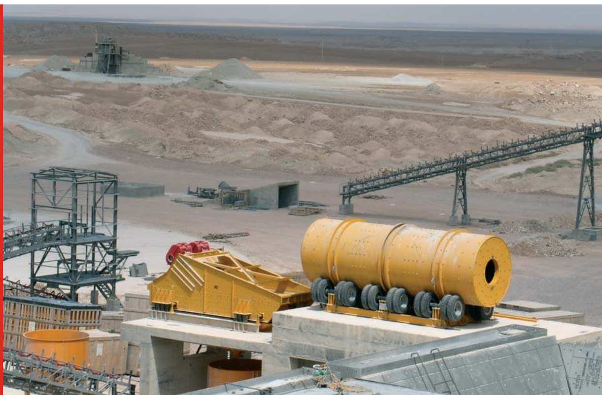
Crible horizontal VTT 2.500 x 6.000 mm avec trommel débourbeur Débit: 500 T/h. Granulométrie: 0/30 mm Produit: Phosphate débourbé Client: NEYRTEC MINERAL - France
